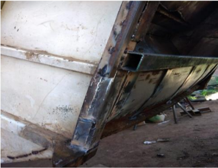
Se reparó el contenedor del camión de aseo público
